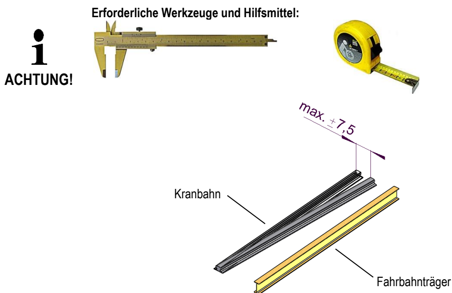
Abb. 9: Horizontaler Versatz der Kranbahn zum Fahrbahnträger
