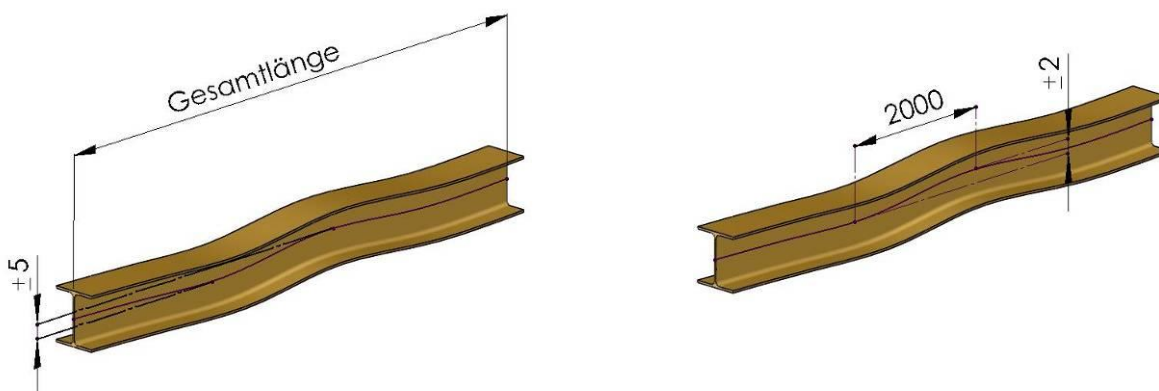
Abb. 8: Vertikale Maßabweichung am Fahrbahnträger
