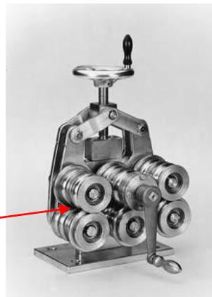
5. Verstellspindel so einstellen, dass die Schiene zu Beginn nur leicht in die gewünschte Richtung gebogen wird. **Die Umdrehungen der Verstellspindel zählen und notieren.**
