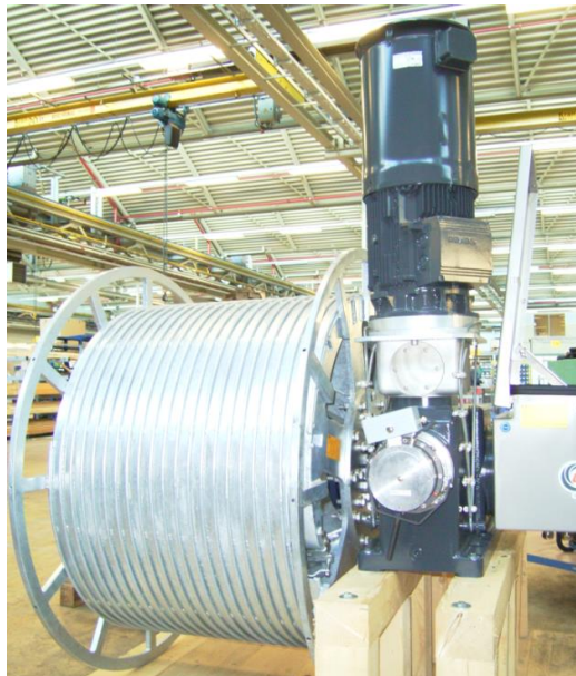
EB-Trommelkörper für definierte Leitungswicklung
