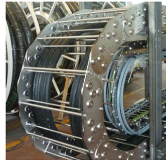
Programme LZ97 und LZ96 mit Leitungsbelegung: linear laufende Kette aus Edelstahl AISI 316L für eine Offshore-Anwendung
