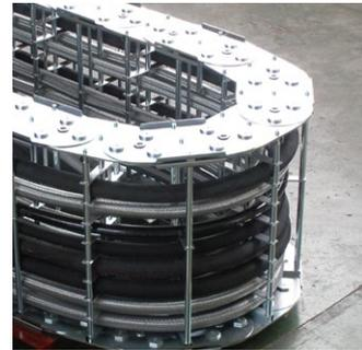
Programm LZ 98 mit Schlauchbelegung: fertig montiert und zum Transport (seitlich liegend) mit Stahlkonstruktion versehen
