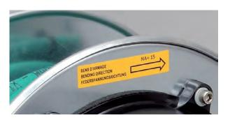
Die Leitungstrommeln werden mit nicht vorgespanntem Federmotor geliefert (außer Optionen BR und SP). Der Motor muss, was die Richtung und die Anzahl Vorspannumdrehungen ,NA' betrifft, beim Aufbau wie auf dem Trommelkörper der Leitungstrommel angegeben gespannt werden.
